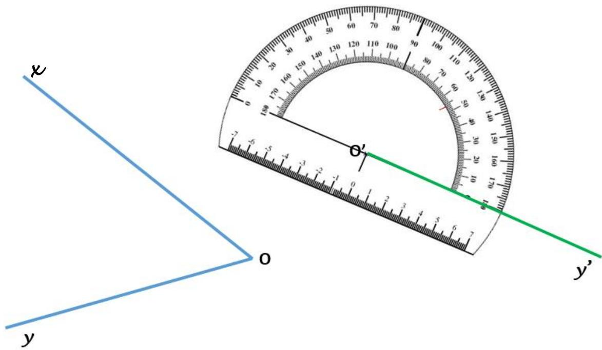
4. Joindre par une demi-droite le point  $O'$  et le trait de repérage  $54^\circ$ .
