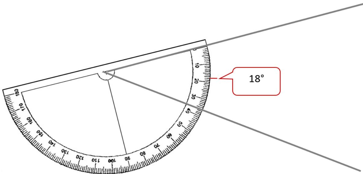
4. Avec une règle, joindre le repère  $18^\circ$  avec le sommet de l'angle par une ligne droite.
