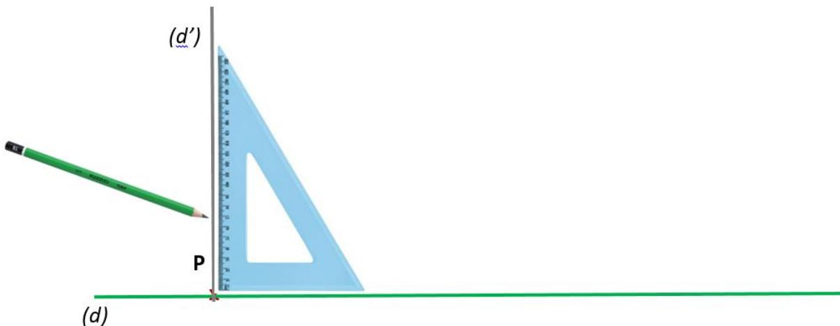
3. Prolonger  $(d')$  en utilisant une règle, on obtient la droite  $(d')$  perpendiculaire à  $(d)$ .
