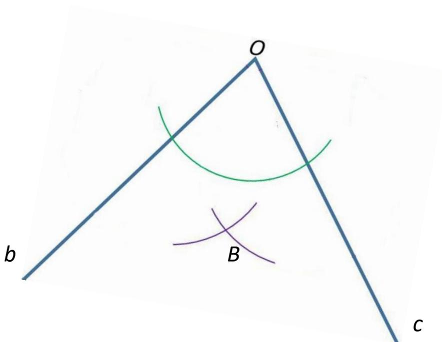
3. Avec une règle, joindre Le sommet de l'angle O avec B le point d'intersection des arcs.
