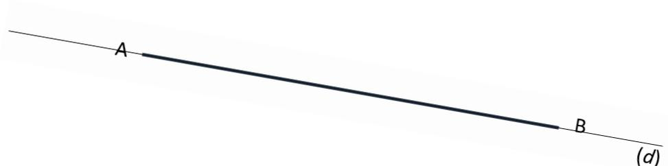
1. Pointer le compas en A et prendre un écart de compas que l'on gardera et tracer un arc de cercle de part et d'autre du segment [AB].
