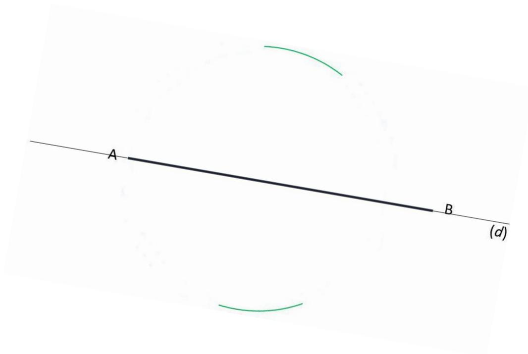
2. Pointer le compas en B et tracer un arc de cercle de part et d'autre du segment  $[AB]$ . Les intersections donnent les points M et N.
